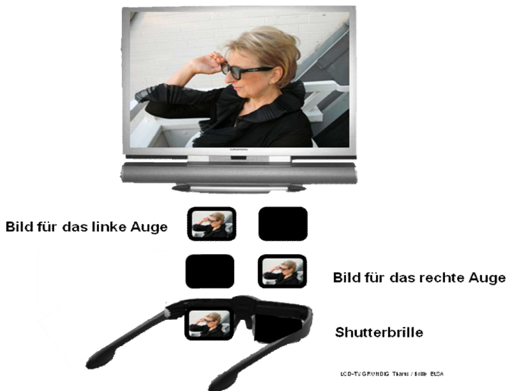
Abb. 4: Das Shutterbrillenverfahren. Die Brille lässt für das linke und das rechte Auge nur das zugehörige Kamerabild passieren.
