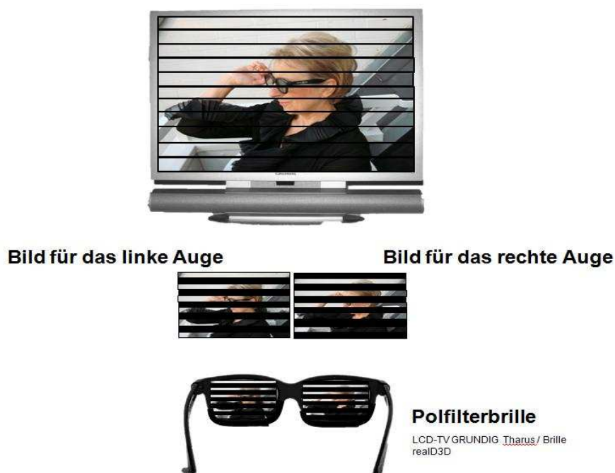
Abb. 5: Das Prinzip des Polfilterverfahrens stark vereinfacht anhand von nur 11 Fernsehzeilen.
